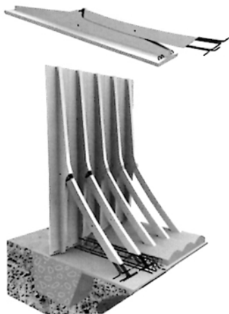
fig. 332 Pour retenir une poussée horizontale, tu te penches pour faire peser ton poids. Ne serait-ce pas une occasion pour laisser une trace de cet effort dans l'ouvrage bâti? Mur de soutènement d'Antonio Gaudi, expression du flux des forces versus une version préfabriquée «moderne» dont la partie expressive est enfouie sous terre.
